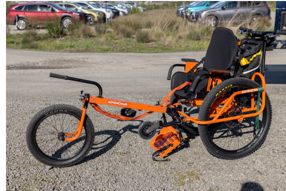
En la imagen, la AdvenChair es una silla de ruedas todoterreno impulsada por el hombre, diseñada para que personas con movilidad reducida puedan disfrutar de forma segura de la serenidad y la grandeza de la naturaleza con familiares y amigos. Foto: Monique Trevett.
